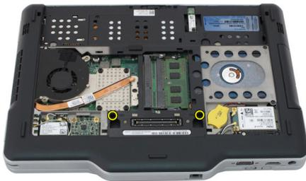
6. Drehen Sie den Computer um und entfernen Sie die Schrauben, mit denen die Tastatur befestigt ist.
