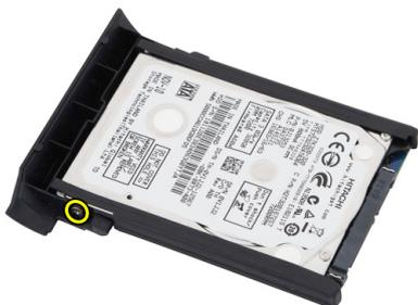
7. Entfernen Sie die Festplattenhalterung und schieben Sie das Gummistück von der Festplatte.
