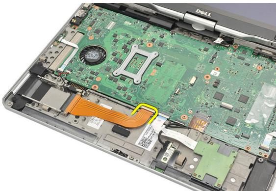
9. Entfernen Sie die Schrauben, mit denen das ExpressCard-Lesegerät befestigt ist.
