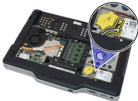
5. Entfernen Sie die Schraube, mit der die WWAN-Karte an der Systemplatine befestigt ist.
