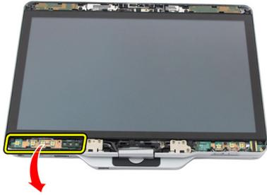
6. Trennen Sie das Kabel vom Anschluss an der Bildschirmstromversorgungsplatine.
