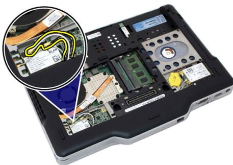
5. Entfernen Sie die Schraube, mit der die WLAN-Karte an der Systemplatine befestigt ist.
