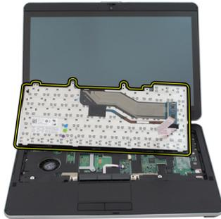
9. Entfernen Sie das Mylarband, mit dem das Tastaturdatenkabel an der Rückseite der Tastatur befestigt ist.
