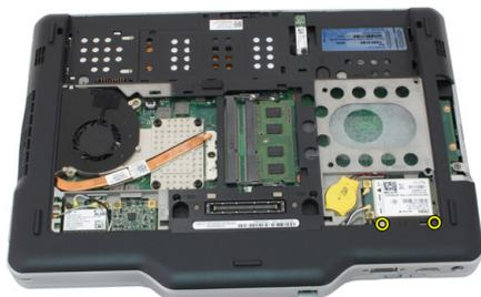
6. Lösen Sie die Abdeckung an der Unterseite von den Kanten und entfernen Sie sie vom Computer.
