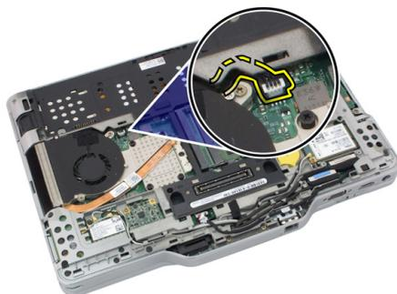
7. Lösen Sie die selbstsichernden Schrauben am Kühlkörper und entfernen Sie die Schrauben am Lüfter.
