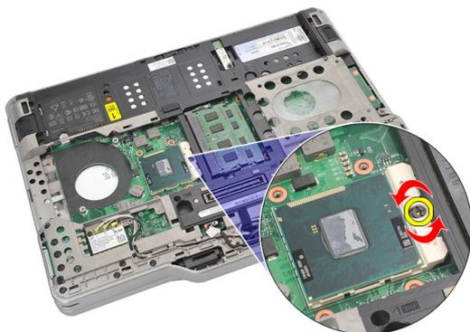
8. Heben Sie den Prozessor hoch und entfernen Sie ihn aus dem Computer.
