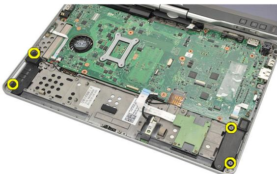
12. Lösen Sie das Lautsprecherkabel und entfernen Sie die Lautsprecher vom Computer.
