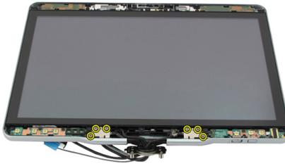
11. Entfernen Sie die Bildschirmscharniere von der äußeren Bildschirmabdeckung.
