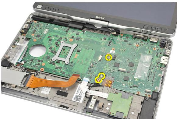
19. Heben Sie die rechte Seite der Systemplatine an, um sie von den Port-Anschlüssen auf der linken Seite zu lösen und entfernen Sie die Systemplatine.
